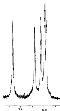
Fig. 3. Ausschnitt der Acetylgruppenregion aus dem 1 H-NMR.-Spektrum (60 MHz, d 5 -Pyridin) von IV B
